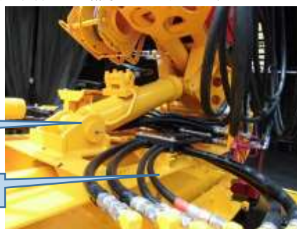
旋回台伸縮フレーム
